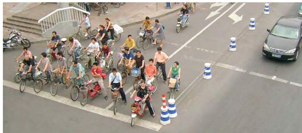
中国杭州，大流量的自行车道上设有物理保护、转弯车道以及比机动车优先的自行车停止线。
